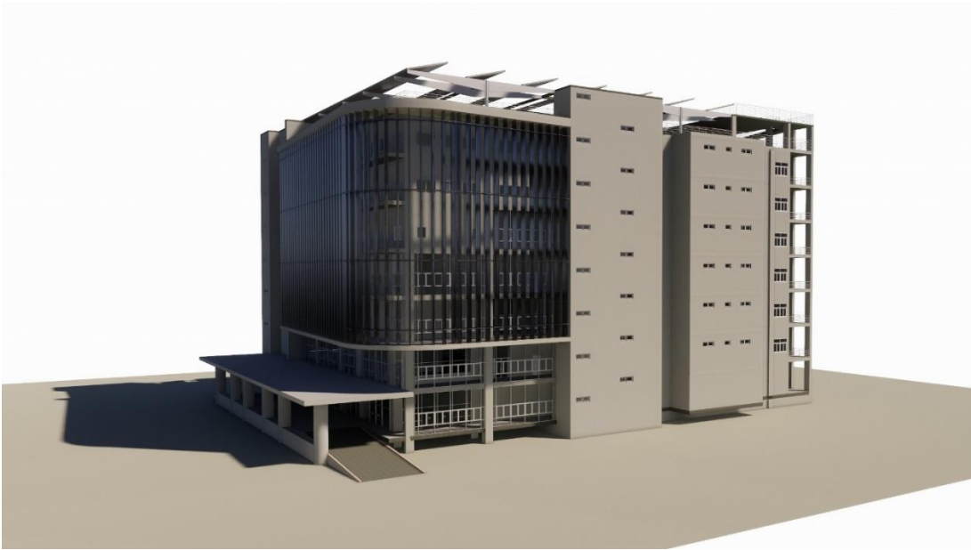
รูปที่ 7 BIM Model ของต้นแบบอาคาร HPHP แบบสูง 7 ชั้น + 1 ชั้นใต้ดิน แผงกันแดดแนวตั้ง
