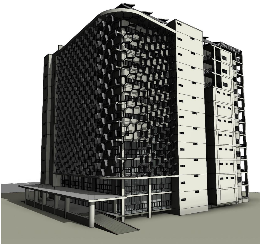
รูปที่ 5 BIM Model ของต้นแบบอาคารสถานบริการสมรรถนะสูงในบริบทไทยแลนด์ 4.0 (HPPH) แบบสูง 11 ชั้น + 1 ชั้นใต้ดิน แผงกันแดดทรงรังผึ้ง
