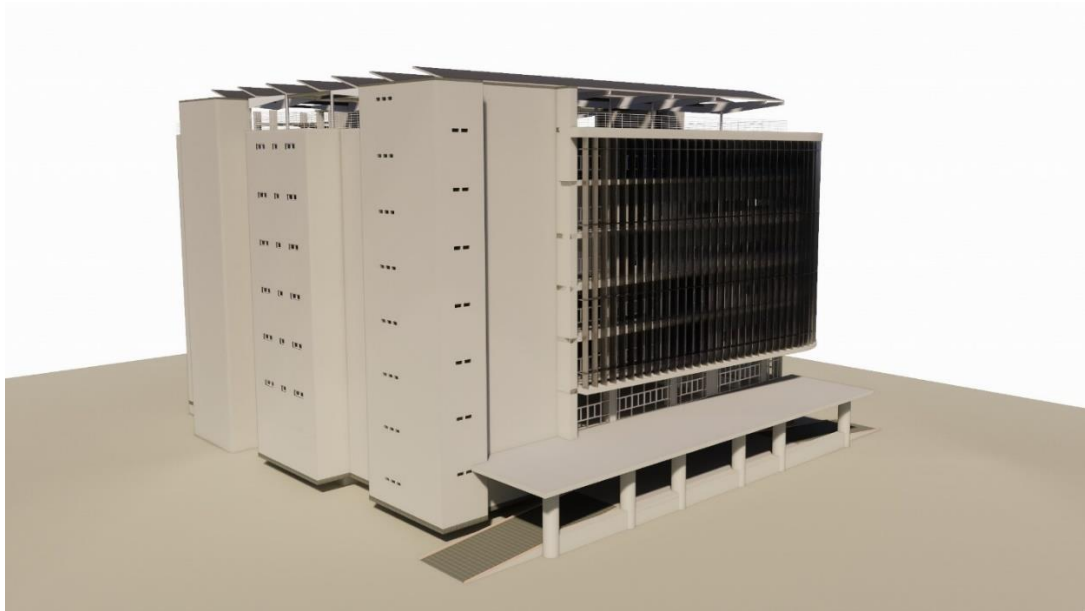
รูปที่ 9 BIM Model ของต้นแบบอาคาร HPHP แบบสูง 7 ชั้น + 1 ชั้นใต้ดิน แผงกันแดดแนวตั้ง
