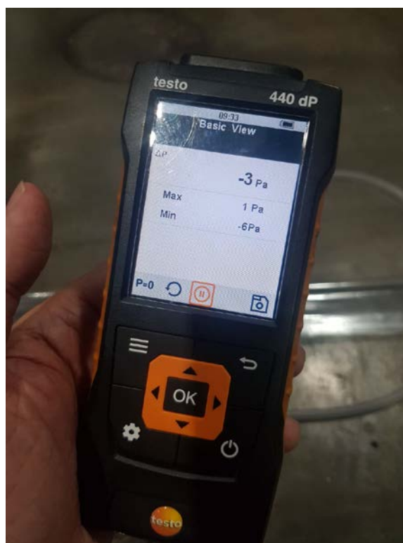
รูปที่ 6 แสดงค่าแรงดันภายใน Tent Negative Pressure
